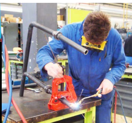
Atelier de façonnage des tubes cuivre, acier noir et acier galvanisé. Les élèves réalisent notamment des coudes, des chapeaux de gendarme et des piquages, en différents diamètres. Photo de gauche : certains travaux sont accrochés au mur. Photo de droite : un élève de terminale effectue une soudure acier noir.
